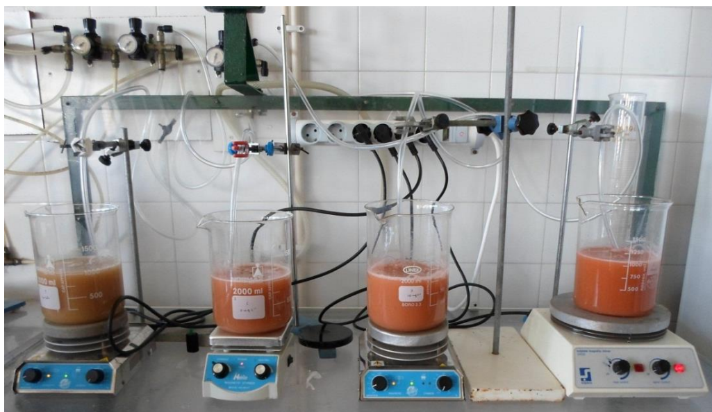
Figura 4.2: Aparato experimental do ensaio de avaliação de efeitos inibidores à actividade microbiana pela eosina Y, com os reactores 1, 2, 3 e 4 da esquerda para a direita, respectivamente.
