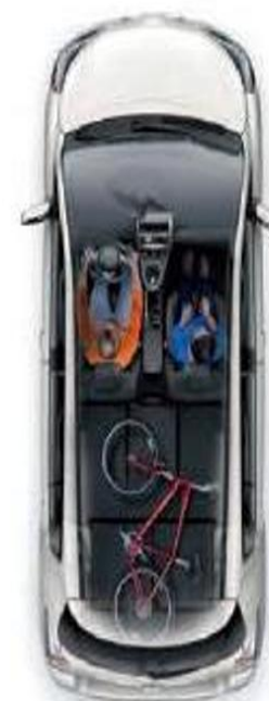
Cria uma superfície de carga plana em segundos , podendo transportar até 1.900 litros (até ao tejadilho). Perfeito para objetos volumosos.
