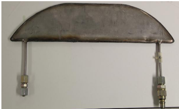
Figura 2: Macaco plano semi-oval utilizado nos ensaios
