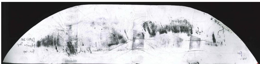
a) Registo químico do ensaio de macacos planos normal sem rede de marcação
