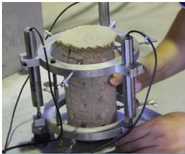
c) Preparação do ensaio, adaptação de sensores
