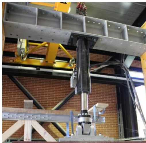
b) Actuador de 300 kN
