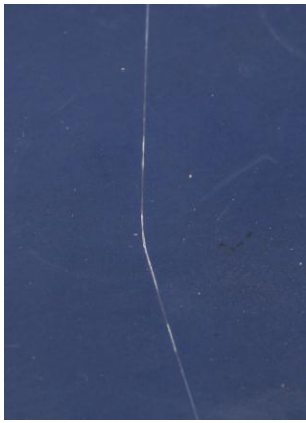
a) Fibra plástica fragilizada
