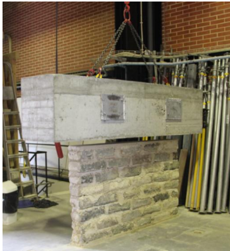
a) Posicionamento da viga de carregamento
