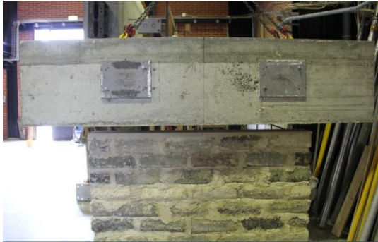
a) Posicionamento da viga de carregamento
