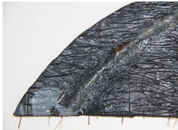
b) Pormenor da fibra embebida no silicone e com M.A.D como base
