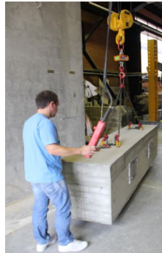
b) Transporte da viga com auxílio da grua
