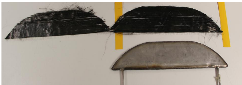
Figura 38: Conjunto formado pelo macaco plano, fibra óptica e envolvente em fibra de carbono
