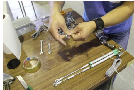
b) Adaptação de extensores aos sensores de acordo com a necessidade dos ensaios
