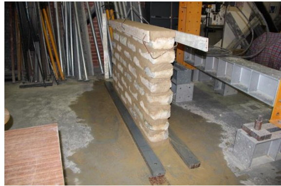
b) Construção de uma camada final de regularização da parede
