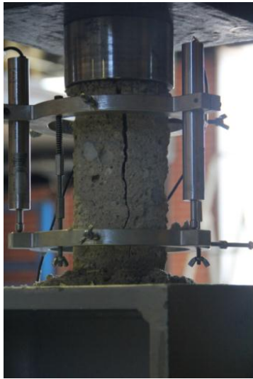
a) Provete de adobe na rotura
