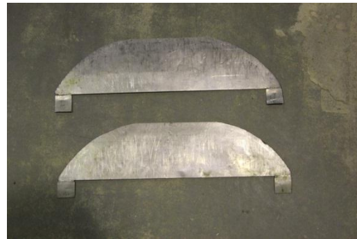
d) Calços metálicos com a forma dos macacos utilizados
