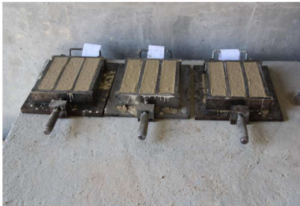
a) Series de provetes paralelepedicos retirados de cada betoneira
