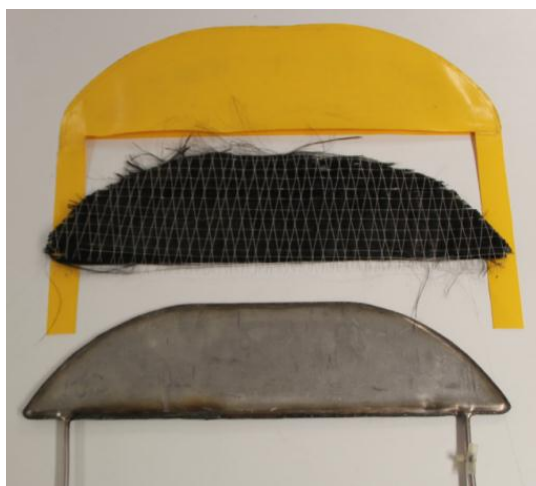
Figura 39: Conjunto formado por macaco, envolvente dos sensores em fibra de carbono e capa exterior em tela comum
