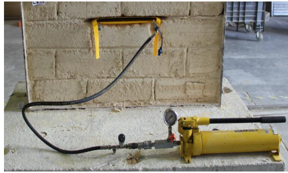
b) Bomba hidráulica e tubo transmissor de pressões
