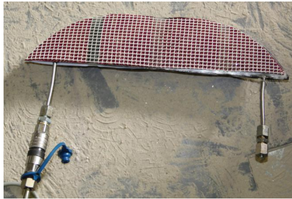
Figura 18: Solução de impressão com rede de marcação da área efectivamente carregada
