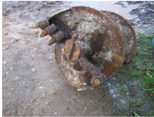
Figura 11. Pormenor da tampa de obturação localizada na broca
