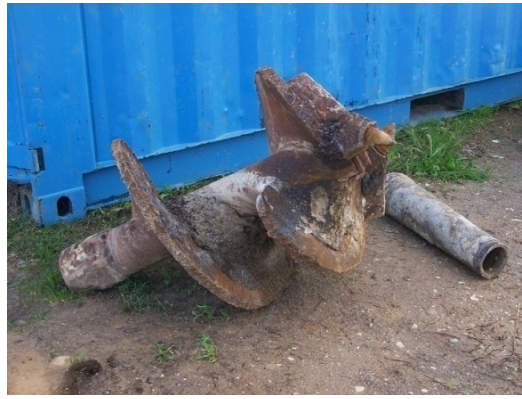
Figura 8. Broca de furação ( \varnothing 600 mm)
