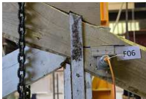
Figura 53 - Potenciômetro de fio aplicado à perna.
