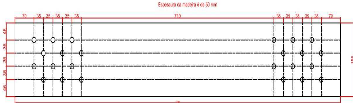
Figura 51 - Esquema de intervenção da perna direita.
