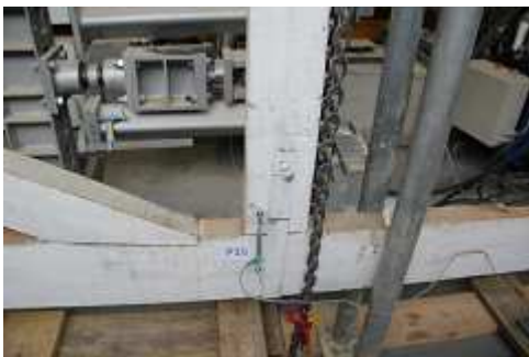
Figura 40 - Potenciômetro aplicado no montante e a linha.
