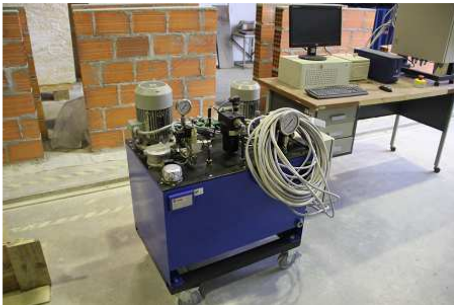
Arquivo fotográfico 4 - Bomba hidráulica.
