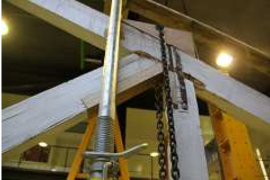
Figura 29 - Reabilitação da escora (ligação 4 e 9).
