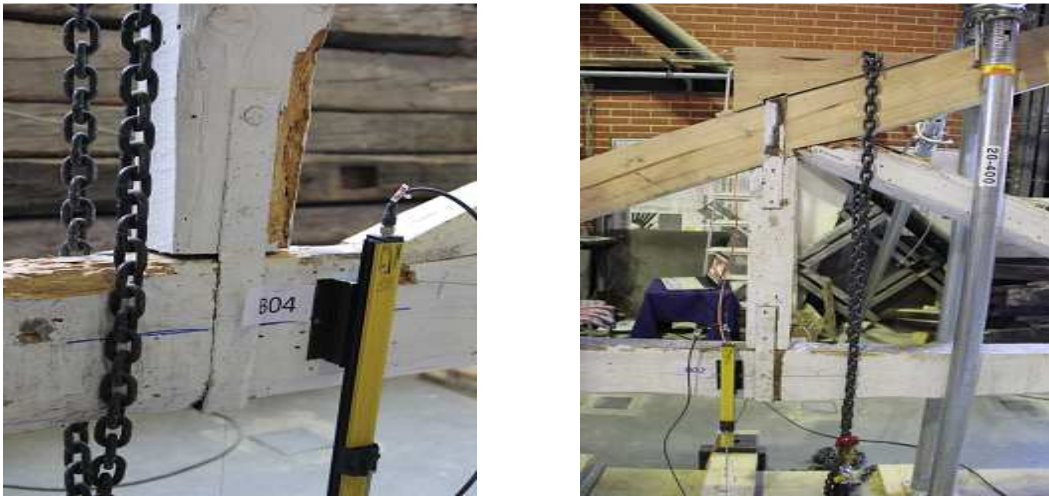
Figura 58 - Potenciômetros aplicados na linha.
