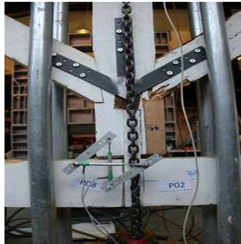
Figura 57 - Potenciômetros aplicados pendural -perna e pendural-linha.
