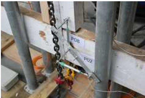
Figura 38 - Potenciômetros aplicados entre o pendural-linha.
