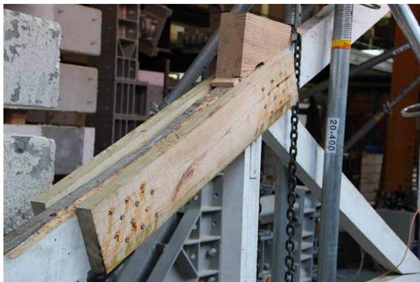
Figura 50 - Intervenção com entalhe de madeira.
