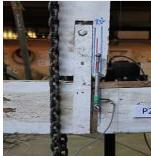
Figura 56 - Potenciômetro aplicado entre pendural-linha.
