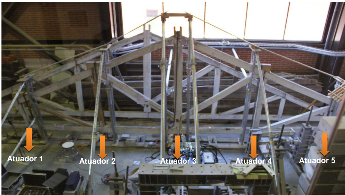
Figura 33 - Asna a ensaiar com o esquema dos atuadores.
