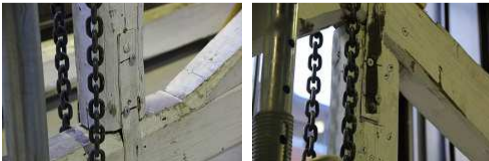
Figura 32 - Chapas aparafusadas com parafusos HBS 10x60.
