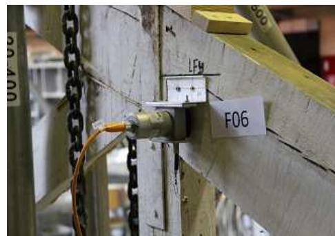
Figura 36 - Potenciômetro de fio aplicado na perna.
