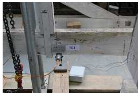
Figura 41 - Potenciômetro de fio aplicado à linha.
