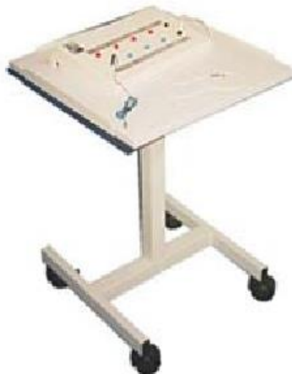
Figura 5 - Unidade de gravação eletro-fisiológico [retirado de (Giannotto, 2009, p. 37)]
