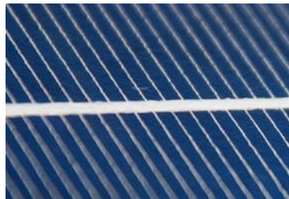
Figura 79 – Pormenor de linhas de ligação da célula solar (mais finas) a barramento (mais grosso).
