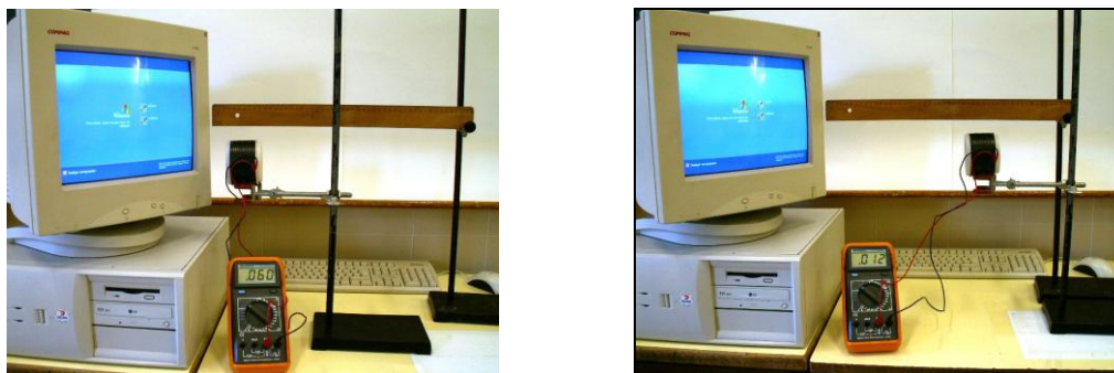
Figura IV. 1 – Montagem experimental que permite analisar a variação do campo magnético com a distância (distância da bobine à fonte do campo).
