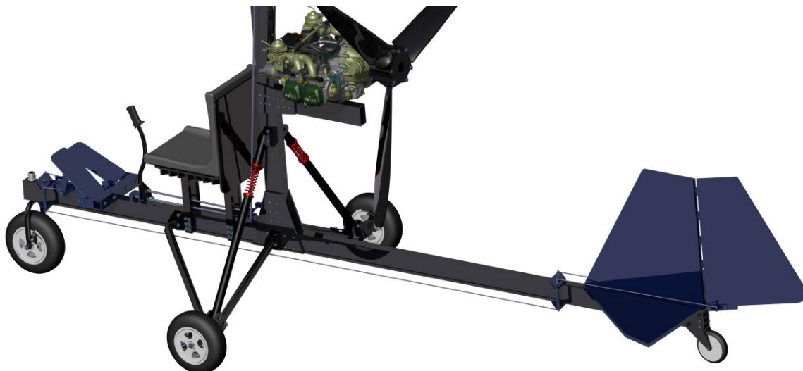
Figura 39- Controlo do estabilizador vertical, deslocando-o para a direita.
