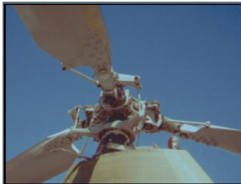
Figura 5-Sistema de rotor totalmente articulado [1].
