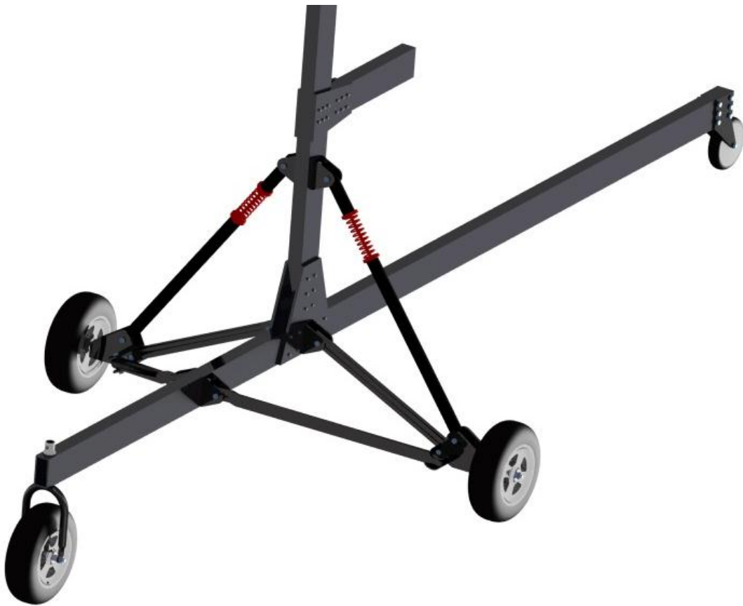
Figura 30-Desenho do trem de aterragem associado á estrutura.
