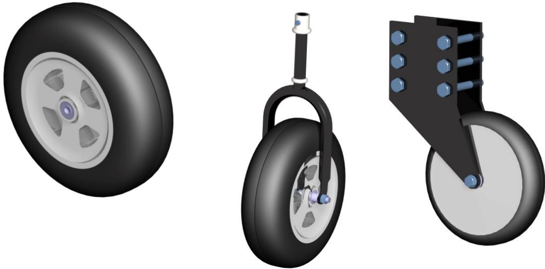
Figura 29-Desenho das rodas que compõem o trem de aterragem.
