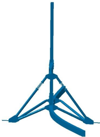
Figura 84- Modo 1 de vibração da estrutura [5.6 Hz].
