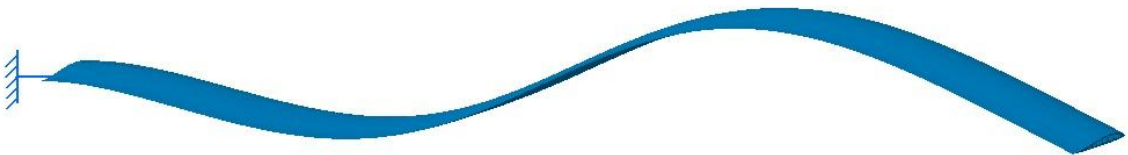
Figura 91- Modo 4 de vibração da asa.
