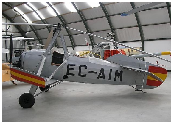
Figura 1-Configuração do tipo tractor [23].
