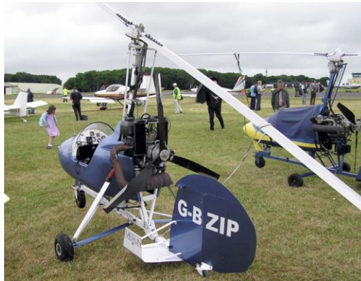
Figura 2-Configuração do tipo Pusher [22].
