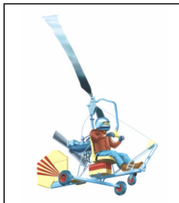
Figura 11-Sistema de controlo cíclico com vareta diretamente por cima do piloto [1].
