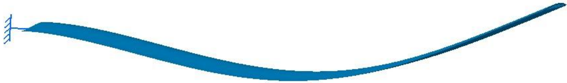
Figura 89- Modo 2 de vibração da asa.
