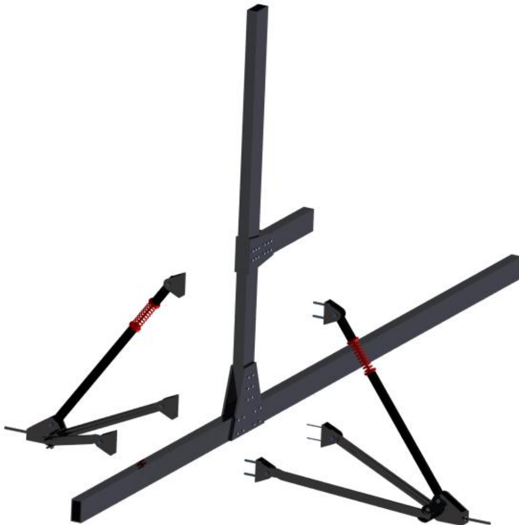
Figura 42-União entre a estrutura e a estrutura de suporte às rodas.
