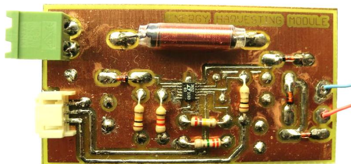
Figura 64: Placa de circuito impresso do circuito de energy harvesting
