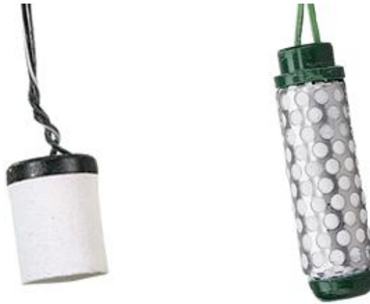
Figura 15: Bloco de gesso (à esquerda); Sensor de matriz granular WATERMARK (à direita)
