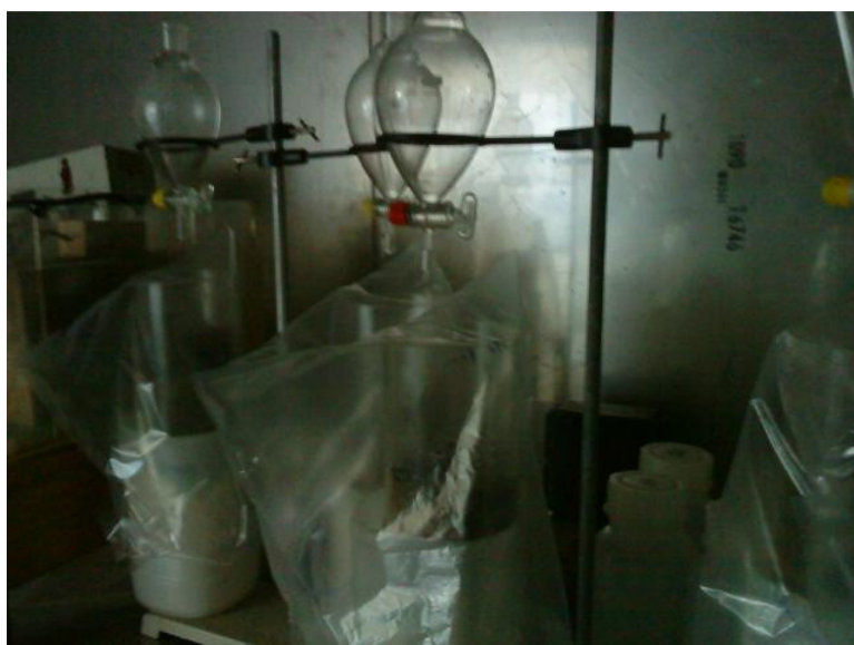
Figura 10: Montagem do ensaio de laboratório: funil para aplicar água e coluna de solo dentro de um copo para recolha da água de percolação.
