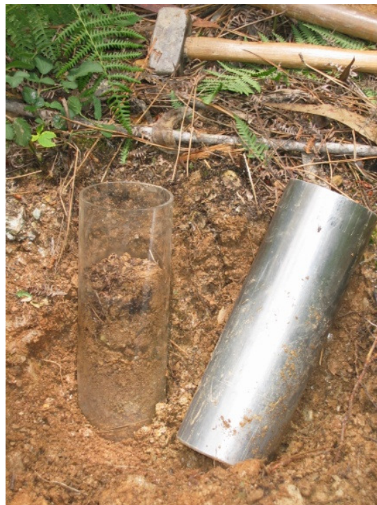
Figura 5: Coluna de solo para ensaio de laboratório.
