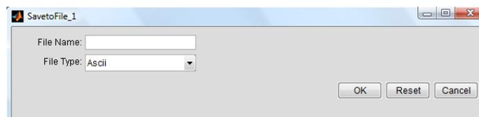
Figura B.60: Parâmetros de configuração do componente SavetoFile.
