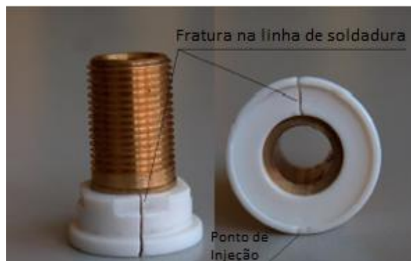
Figura 21- Sobremoldação do PBT num inserto de bronze (adaptado de [12]).
