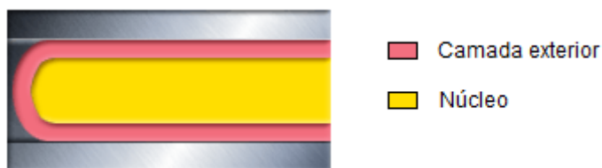
Figura 4: Seção transversal de uma estrutura “sanduíche” obtida através do processo de coinjeção (adaptado de [9]).
