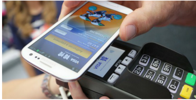
Figura 3.16: Ilustração de um pagamento através da tecnologia NFC[19].
