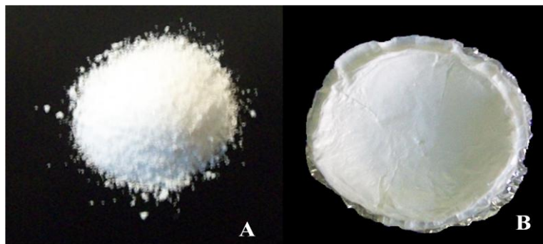
Figura 8 – A: Micropartículas de titanossilicato AM-1; B: Membrana de celulose bacteriana
